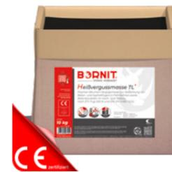
Bitumen-HeiÙvergussmasse zum Abdichten von Fugen nach ZTV Fug-StB 15 und DIN EN 14188-1 (CE) in Betonfahrbahnen, bei Ausbesserungsarbeiten auf Asphaltbelägen sowie Verfugung von Betonbauteilen im Hoch- und Tiefbau, dehnbar mindestens 5mm bei -20°C. Grundierung mit BORNIT®-Haftgrund oder BORNIT®-Haftgrund Fix.
