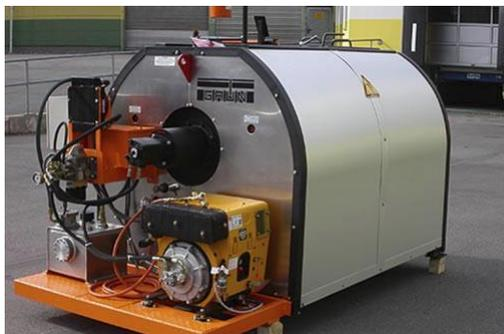
Équipement pour chauffer et appliquer des masses de marquage routier thermoplastiques et des masses bitumineuses et du mastic de scellement pour rails
