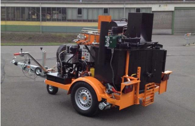
Equipement pour chauffer et appliquer des masses bitumineuses et du mastic de scellement pour rails.
