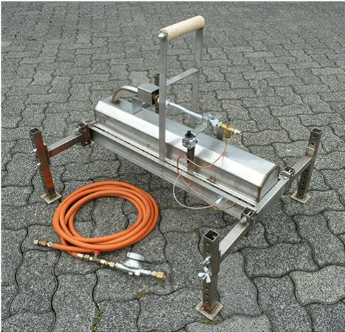
Zur schnellen und schonenden Erhitzung von Asphaltflächen und Nahtverbindungen
