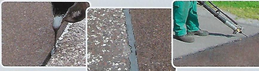
**BORNIT®-Masse de scellement à chaud TL / BORNIT®-Masse de scellement de pavés** - Masse de scellement à utiliser à chaud (max. 180 °C) à base de bitume polymère. Couche de fond avec **BORNIT®-Couche d'adhérence**.
